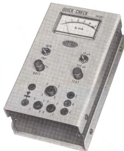
Un apparecchio pratico, di facile uso, leggero e facilmente portatile. Misura il beta dei transistori NPN e PNP, e fornisce una chiara indicazione della funzionalità di transistori e diodi pur senza necessitare di complicate procedure di misura o di calcoli. Indispensabile nella borsa e nel laboratorio.
