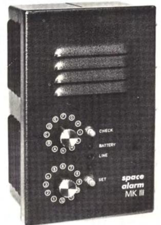
144 combinazioni, due spie luminose per lo stato di carica delle batterie e la messa in funzione dell'apparecchio. Funzionante con contatti normalmente chiusi o aperti. Microsirena incorporata, con potenza di 6W. Può comandare una sirena esterna di alta potenza. Alimentazione a 220V c.a. oppure 9V c.c. con 6 torce da 1.5V.
