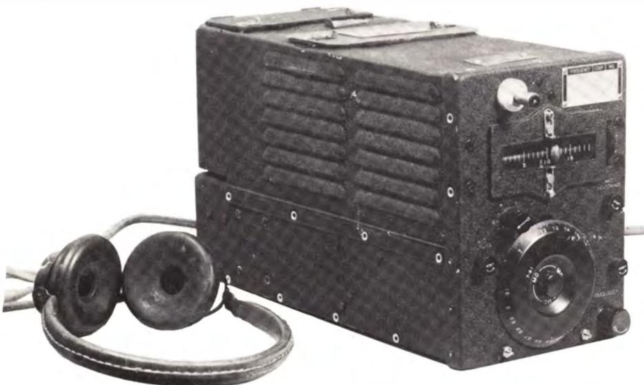
Fig. 3 - Aspetto del BC 479A (SCR 274N) - La cuffia serve solo per avere un'idea delle dimensioni.
